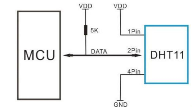
Fig 3.2: DHT11 pin configuration
